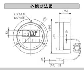
TAD-2120K(AC電源仕樣)・TAD-2120KD(乾電池仕樣) 本体:-200~1,200
